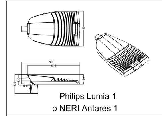
**Particolare sistema palo e apparecchio luminoso Singolo punto luce**
